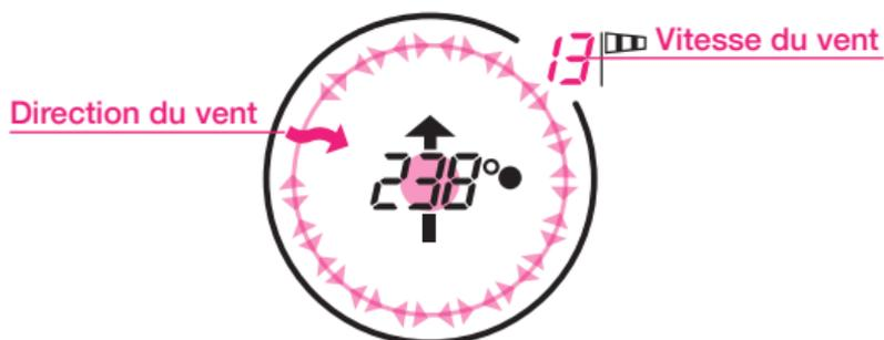
**Indicateur de vent** - La flèche extérieure (direction du vent) tournera dans les deux directions indiquant **d'où le vent souffle**, étant donné que le centre du cercle est votre position. Les données en haut à droite indiquent la vitesse du vent.
