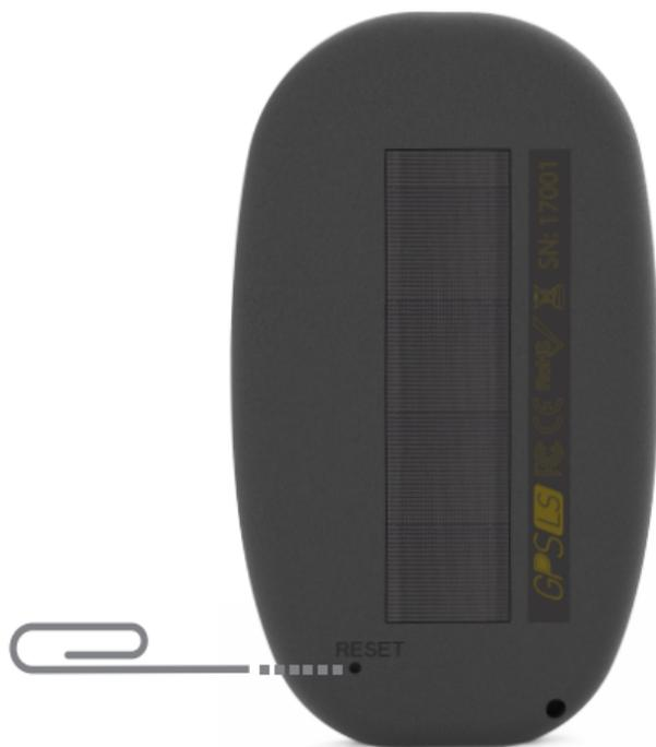
**2.** Mettez le GPS LS en mode «Fail safe»: maintenez le bouton d'alimentation / menu enfoncé tout en appuyant sur le bouton de réinitialisation. Le GPS doit afficher le texte «SAFE» sur la zone graphique. Le firmware peut maintenant être installé en utilisant une mise à jour manuelle (chapitre 4), ou, quittez le «Fail safe», en appuyant à nouveau sur le bouton de réinitialisation.
